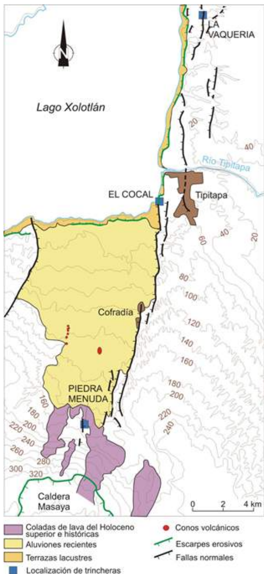
Figura 3. Esquema de la parte meridional de la falla de Cofradía, en el límite oriental del graben de Managua. Se indica con cuadrados azules las localidades donde se han abierto trincheras.
